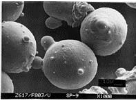
Сплав Ni-Co-Cr-Al-Y – распыление в инертной среде, x1000
