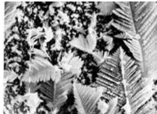
Дендрит Zn, полученный электрохимическим осаждением
