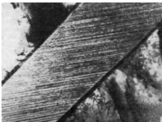
Рис. 3. Кристаллы мартенсита, состоящие из двойников, х40000 [8]
