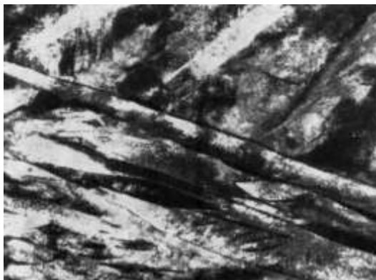
Рис. 2. Пакеты мартенситных пластин, разделённых малоугловыми границами, х35000 [8]
